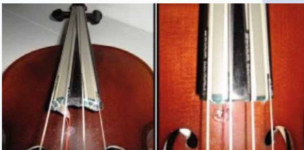
Figura 3 - Force Sensing Resistor™ by 3M incollato sulla tastiera del violino. (Lo strumento utilizzato è stato gentilmente messo a disposizione dall'amico ingegnere Dott. Enrico de Bernardis).
